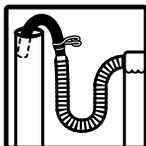
Le tuyau flexible d'évacuation est-il plus bas que le niveau de l'eau dans la laveuse? Il doit être plus haut.
