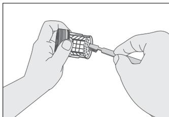
4. 清除過濾網上的所有污垢或其他雜物。確保過濾網背後的排水泵螺旋槳未堵塞。重新裝上過濾網蓋。
