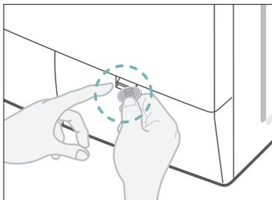
3. 向左擰開緊急排水蓋。捏住緊急排水管末端的蓋子，緩緩拉出約 15 cm。
