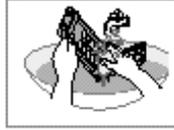
4. Cierre la tapa e inserte la parte inferior del filtro en la canasta primero y luego empuje el filtro con el sonido de golpe.
