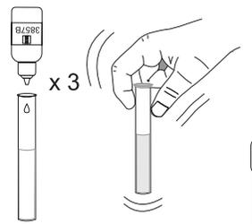
7- Mediante la pipeta de plástico de 3 mL, añada exactamente 5 mL de cloroformo. El cloroformo irá al fondo del vial porque es más pesado que el agua.
