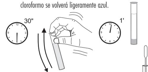
9- Mediante la pipeta larga de plástico, elimine la capa acuosa superior y deshágase de ella. **No elimine** también la capa inferior de cloroformo!
