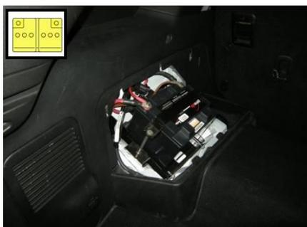
5. Retirar las cubiertas de la batería de 12 voltos en el maletero y desembornar la batería
