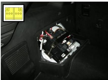
4. Retirar las cubiertas de la batería de 12 voltos en el maletero y desembornar la batería .
