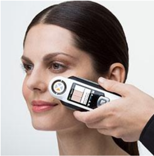
El colorímetro X-Rite CAPSURE para el sector de la cosmética - puede medir con detalle los colores de la piel
