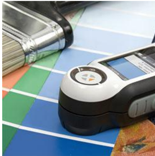
El colorímetro X-Rite CAPSURE para tiendas relacionadas con el color - puede medir distintos materiales y superficies
