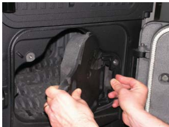
Fig. 14 Desmontaje de la rejilla
