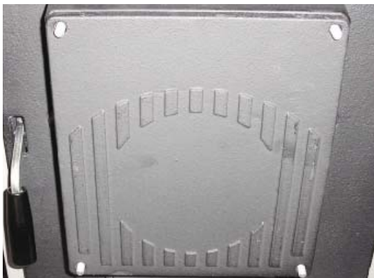
Fig. 13 Desmontaje de la brida ciega
