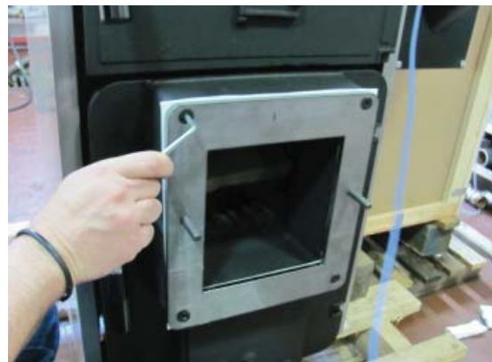
Fig. 23 Brida fijada a la puerta de la cámara de combustión
