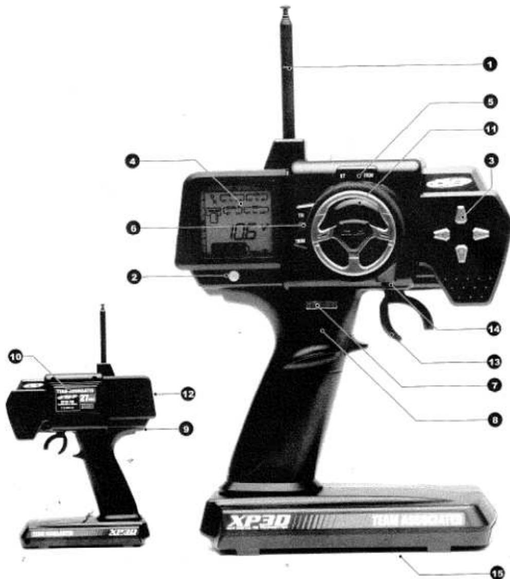
1. **Antena transmisora:** nunca haga funcionar la emisora sin la antena completamente extendida.
