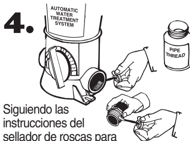
Dos bujes roscados de 2 pulgadas por 1-1/2 pulgada
