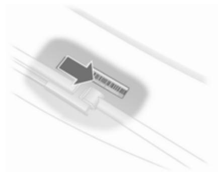
El número de identificación del vehículo también puede ir estampado en el tablero de instrumentos, visible a través del parabrisas.
