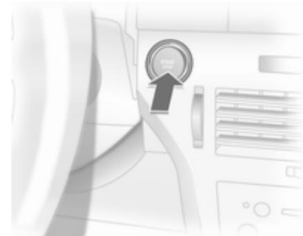
La llave electrónica debe estar en el interior del vehículo. Accione el embrague y el freno, cambio automático en **P** o **N**, no acelere; con motor diésel: pulse brevemente el botón para iniciar el precalentamiento, mueva ligeramente el volante para desactivar el bloqueo, espere hasta que se apague el testigo de control y luego pulse el botón durante 1 segundo y suéltelo cuando el motor esté en marcha.
