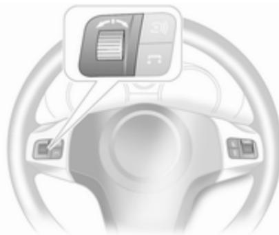
Pulse la rueda de ajuste para abrir el menú **BC**. En el menú **BC**, pulse para accionar el cronómetro o reiniciar la medición y el cálculo.
