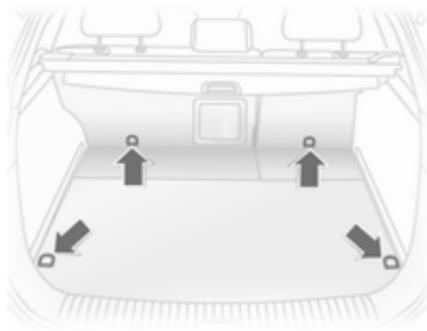
Las argollas están diseñadas para fijar las correas de amarre, una red para el equipaje o una red de seguridad, y evitar que se desplacen los objetos transportados.
