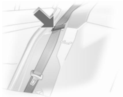
Antes de volver a colocar el respaldo en posición vertical, guíe el cinturón de seguridad a través de las guías del cinturón para protegerlo de daños.
