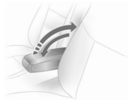
Presione el reposabrazos levantado hacia atrás, superando la resistencia, y bájelo.
