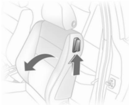
Levante la palanca de desbloqueo e incline el respaldo hacia adelante. Deslice el asiento hacia adelante.
