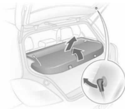
Desenganche las cintas de sujeción del portón trasero. Extraiga la cubierta de las guías laterales.
