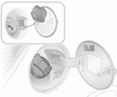
El tapón del depósito se puede enganchar en el soporte de la tapa del depósito de combustible.
