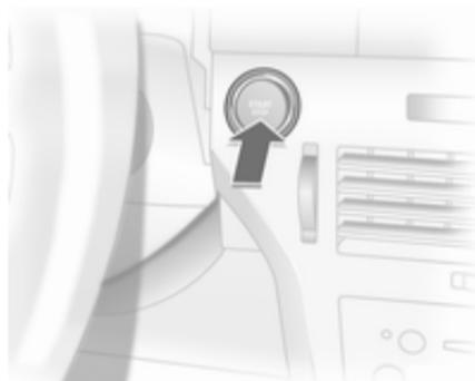
La llave electrónica debe estar en el interior del vehículo. Accione el embrague y el freno, cambio automático en **P** o **N**, no acelere; con motor diésel: pulse brevemente el botón para iniciar el precalentamiento, mueva ligeramente el volante para desactivar el bloqueo, espere hasta que se apague el testigo de control y luego pulse el botón durante 1 segundo y suéltelo cuando el motor esté en marcha.
