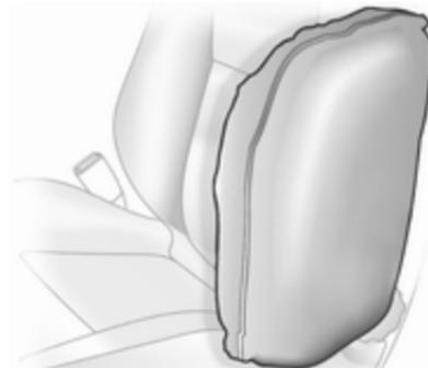
Los airbags inflados atenúan el impacto y reducen, por tanto, el riesgo de lesiones en la parte superior del cuerpo y la pelvis en el caso de que haya una colisión lateral fuerte.
