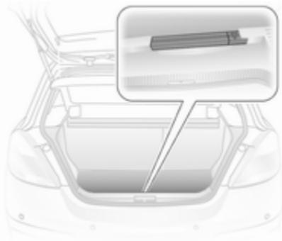
Guarde el triángulo de advertencia en la pared trasera del compartimento de carga: coloque primero el triángulo de advertencia en el rebaje de la izquierda y luego insértelo en la guía de la derecha.
