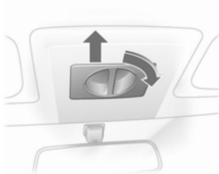
Para abrir el revestimiento del techo: gire el asidero hacia la derecha y desplace el revestimiento del techo hacia atrás, hasta una posición adecuada.
