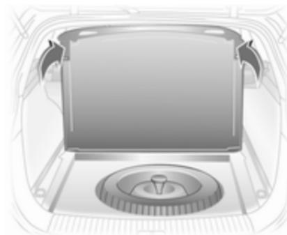
Retire los adaptadores y ganchos de los carriles en las paredes del compartimento de carga. Suba las argollas traseras y levante la cubierta del piso hasta la posición vertical, de modo que se apoye en el revestimiento del techo. Al cerrar, guíe las argollas a través de las ranuras en la cubierta del piso. Vehículos con Cargo box: desmontaje ⇨ 78.
