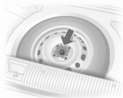
La rueda de repuesto está en el compartimento de carga, debajo de la cubierta del piso. Está fijada en el rebaje mediante una tuerca de mariposa.
