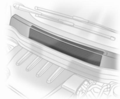
Las entradas de aire en el compartimento del motor, delante del parabrisas, deben estar libres para permitir la entrada de aire. Retire cualquier resto de hojas, suciedad o nieve.
