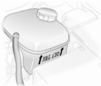
Con el sistema de refrigeración frío, el nivel del refrigerante debería estar justo por encima de la marca **KALT/COLD**. Rellene si el nivel es más bajo.
