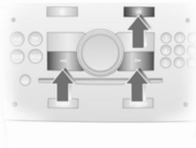
Seleccione las opciones mediante los menús y con los botones del sistema de infoentretenimiento. El botón **OK** se usa para seleccionar la opción marcada o para confirmar una orden. Para salir de un menú, pulse la tecla de flecha derecha o izquierda hasta que aparezca **Atrás** o **Main** y seleccione la opción deseada.
