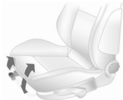
Tire de la palanca, ajuste la inclinación desplazando el peso del cuerpo. Suelte la palanca y enclave audiblemente el asiento en su posición.
