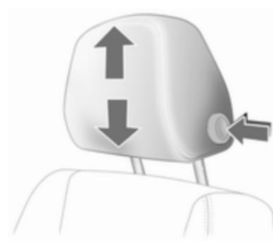
Pulse el botón de desbloqueo, ajuste la altura, enclave.
