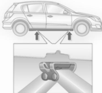
3. Asegúrese de que el gato esté correctamente colocado en los puntos de elevación del vehículo.
