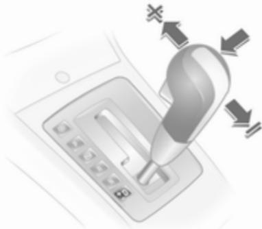
Mueva la palanca selectora desde la posición **D** hacia la izquierda y luego hacia delante o hacia atrás.
