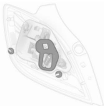
8. Asegúrese de que se han colocado las juntas en el portálamparas y los tornillos de fijación.
