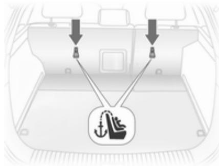
Además del soporte de montaje ISOFIX, fije la correa del anclaje superior a las argollas de fijación para el anclaje superior. La correa debe pasar entre las dos varillas guía del reposacabezas.
