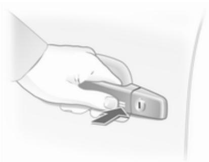
Toque el campo del sensor en la manilla de la puerta delantera dos veces en menos de 15 segundos.
