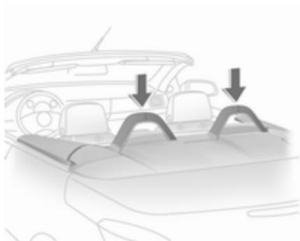
Las barras antivuelco fijas van unidas a la carrocería del vehículo.
