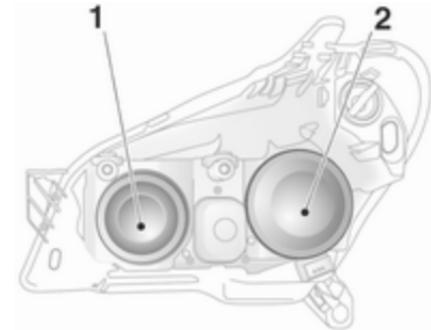
Los faros tienen sistemas independientes para la luz de carretera **1** (bombillas interiores) y la luz de cruce **2** (bombillas exteriores).
