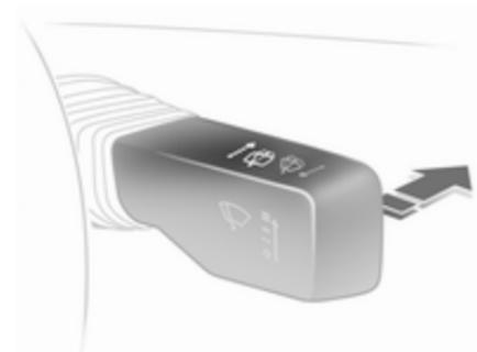
Presione la palanca hacia delante. El limpiaventana funciona a intervalos. Para desconectarlo, vuelva a presionar la palanca hacia delante.
