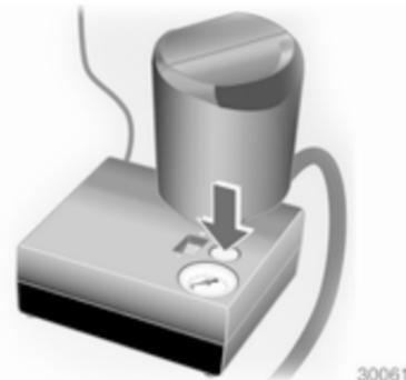
13. La presión prescrita para el neumático debería alcanzarse en un plazo de 10 minutos. Presión de los neumáticos  $\varnothing$  257. Una vez alcanzada la presión correcta, desconecte el compresor. Si la presión prescrita no se alcanza en un plazo de 10 minutos, desconecte el juego de reparación de neumáticos. Haga girar el neumático una vuelta completa. Vuelva a conectar el juego de reparación de
