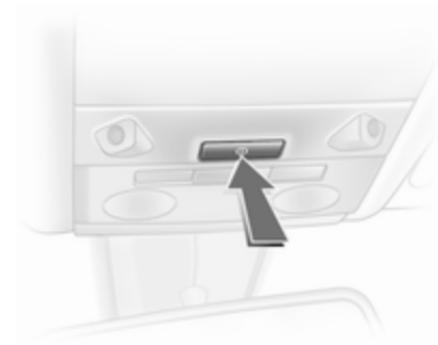
Desconecte la vigilancia del habitáculo y de la inclinación del vehículo cuando se queden personas o animales en el vehículo, debido al elevado volumen de señales ultrasónicas y que los movimientos dispararán la alarma, así como al transportar el vehículo en ferry o tren.
