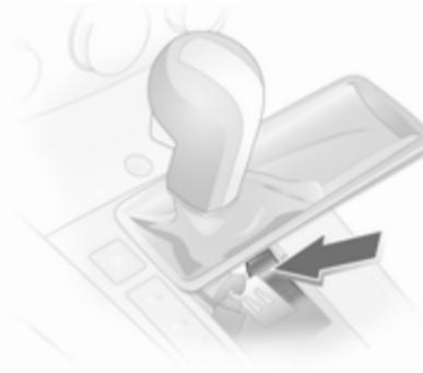
3. Con un destornillador, empuje el trinquete amarillo hacia delante y saque la palanca selectora de **P**.
