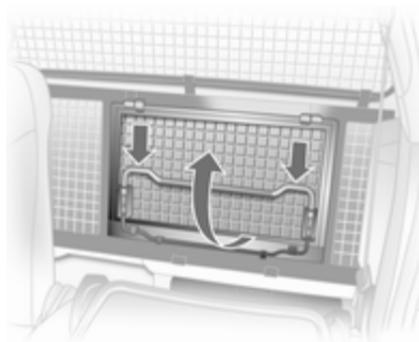
Para transportar objetos largos, se puede abrir una parte de la rejilla del compartimento de carga detrás del asiento del acompañante:
