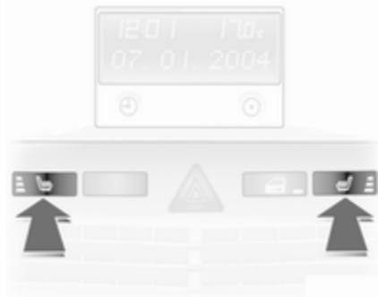
Con el encendido conectado, pulse una o varias veces el botón
