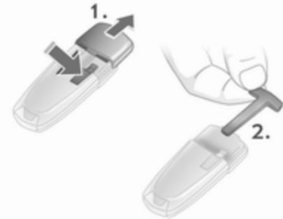
Si también falla el mando a distancia, puede desbloquearse o bloquearse la puerta del conductor con la llave de emergencia alojada en la llave electrónica: pulse el mecanismo de bloqueo y desmonte la tapa ejerciendo una ligera presión. Desplace la llave de emergencia hacia fuera, sobre el dispositivo de enclavamiento, y sáquela.
