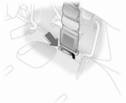
Ajuste la longitud de las correas de la red de seguridad colgando el gancho superior en la argolla de la correa y engánchelas en las argollas a la derecha y a la izquierda del piso.
