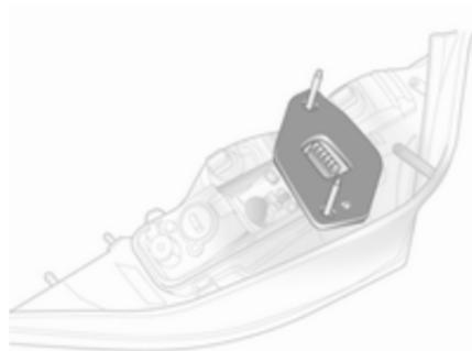
7. Monte la junta en el portalámparas. Asegúrese de que la junta quede plana en la zona de los tornillos.
