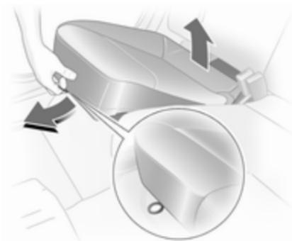
Tire del lazo que hay en la banqueta de asiento y levante hacia delante la banqueta (de una pieza o dividida).
