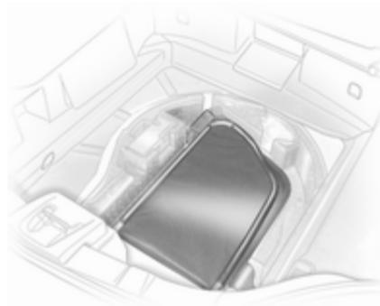
Desmunte en orden inverso y guarde el deflector de viento completamente plegado en el compartimento de carga:
