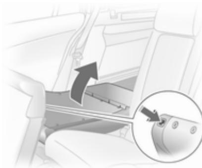
Con las banquetas de asiento levantadas: inserte los reposacabezas en los respaldos y ajústelos ↻ 48. Vuelva a bajar las banquetas de asiento, asegurándose de que los cierres de los cinturones estén bien colocados.
