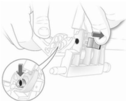
Una los extremos del deflector de viento una vez desplegados: inserte el pasador en la corredera, guíe la bisagra sobre el pasador y suelte la corredera, de modo que el pasador se enclave en la bisagra.
