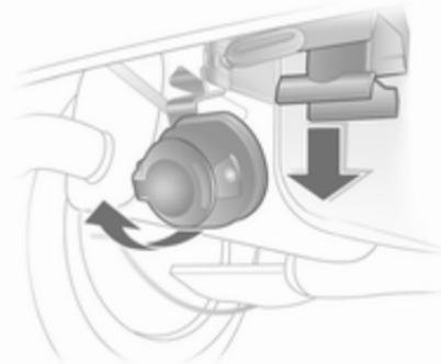
Despliegue la toma. Desmonte el tapón de la abertura para la barra de rótula y guárdelo en el compartimento de carga.
