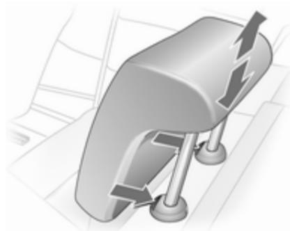
Tire hacia arriba del reposacabezas o pulse ambos resortes de retención para desbloquearlos y baje el reposacabezas.
