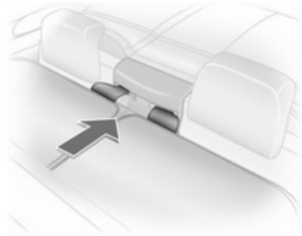
Inserte las lengüetas guía del deflector de viento en los alojamientos de los cinturones de seguridad entre los reposacabezas traseros.
