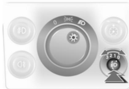
Para adaptar el alcance de los faros a la carga del vehículo y evitar el deslumbramiento: pulse el botón para desactivarlo y gírelo a la posición requerida.
