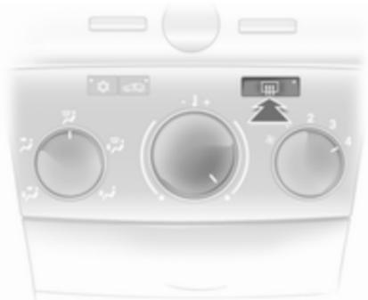
La resistencia térmica se acciona pulsando el botón
