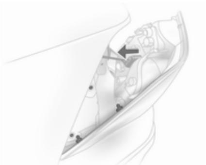
4. Presione las luces traseras hacia atrás, sujetando el grupo óptico desde el exterior. Desconecte el enchufe del portalámparas.
