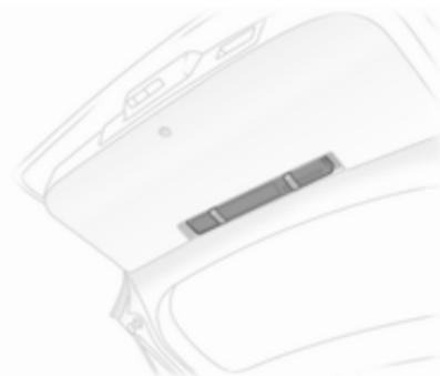
Guarde el triángulo de advertencia en el espacio del portón trasero y fíjelo con las sujeciones a ambos lados.
