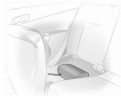
Desmonte los reposacabezas exteriores traseros y baje completamente el reposacabezas central ⇨ 48.
