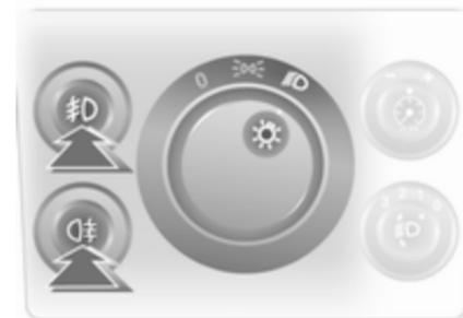
Los faros antiniebla sólo se pueden encender cuando están conectados el encendido y los faros o las luces laterales.
