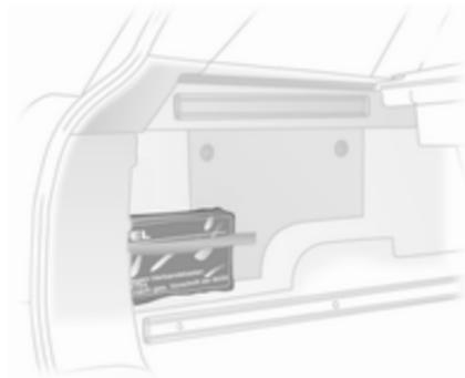
Fije el botiquín a la pared derecha del compartimento de carga con una cinta de sujeción.
