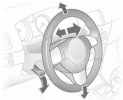
Desbloquee la palanca, ajuste el volante, luego enclave la palanca y asegúrese de que esté totalmente bloqueada. El volante sólo se debe ajustar con el vehículo parado y la dirección desbloqueada.
