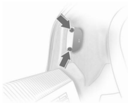
2. Afloje y desmonte los tornillos detrás de la tapa usando una llave para tornillos convencional.
