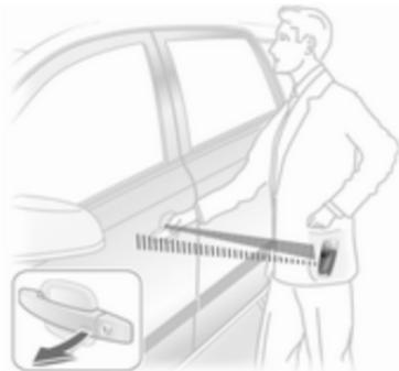
Si lleva consigo la llave electrónica, sólo tiene que tirar de la manilla de la puerta para desbloquear el vehículo y abrir la puerta. Para abrir el portón trasero, pulse el botón situado debajo de la moldura.
