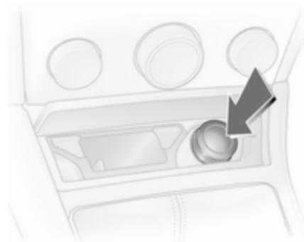
Pulse sobre el encendedor. Cuando esté incandescente, se desconectará automáticamente. Extraiga el encendedor.
