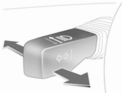
Para cambiar de luz de cruce a luz de carretera, pulse la palanca.
