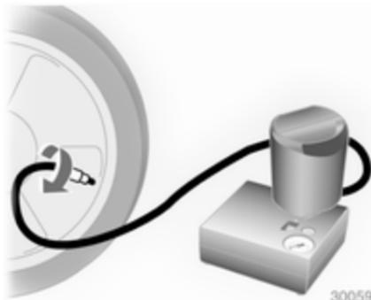
6. Desenrosque el tapón de la válvula del neumático averiado.
