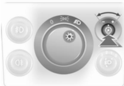
Se puede ajustar el brillo cuando las luces exteriores están encendidas: Pulse el botón ☼ para desenclavarlo y luego gírelo hasta obtener el brillo deseado.
