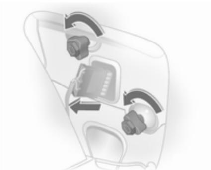
3. Afloje las tuercas de fijación con la llave para tornillos de rueda y desenrózuelas a mano. Herramientas del vehículo ⇨ 199.
