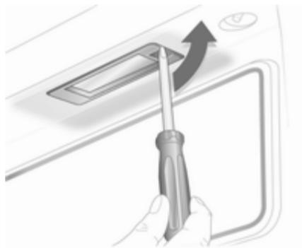
1. Inserte un destornillador en la caja, presione hacia un lado y desbloquee el muelle.
