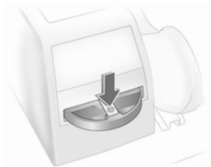
Para vaciar el cenicero, presione sobre el resorte y tire del cenicero en posición recta hacia atrás.
