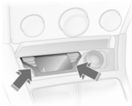
Para vaciarlo, sujete la cubeta del cenicero por ambos lados y tire hacia arriba.
