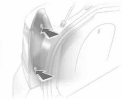
3. Desenrosque los tres tornillos con un destornillador y desmonte el portalámparas. Herramientas del vehículo ⇨ 199.
