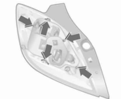
5. Desenrosque los tres tornillos con un destornillador. Presione las lengüetas de bloqueo en el exterior del portalámparas hacia dentro y desmonte el portalámparas.
