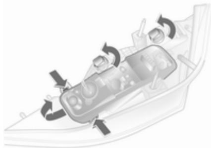
4. Desenclave los casquillos girándolos y desmóntelos. Presione las lengüetas de bloqueo en los laterales del portalámparas hacia fuera; levante el portalámparas por el lado delantero y desmóntelo.
