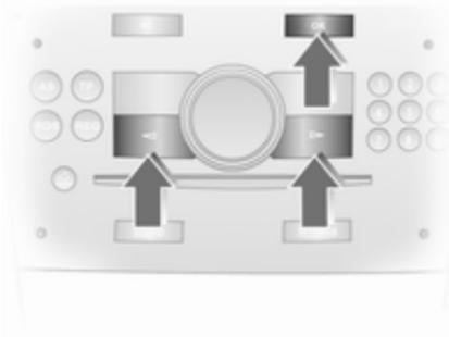
En el menú **Ajustes**, utilice el botón **OK** para acceder a la función requerida. Utilice las teclas de flecha para cambiar los ajustes.
