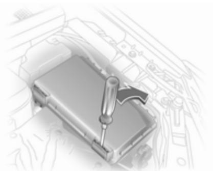
Inserte un destornillador en la abertura hasta el tope y muévelo hacia un lado. Levante la tapa hacia arriba y desmóntela.
