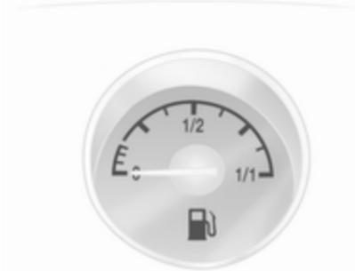
Indica el nivel de combustible en el depósito según el modo de funcionamiento.
