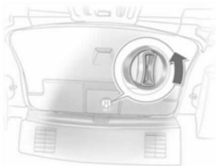
Desde el interior, gire el asidero del interior de la tapa del maletero en sentido antihorario hasta que se desbloquee la tapa del maletero y se abra ligeramente.
