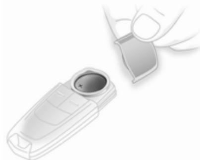
Para sustituir la pila, pulse el mecanismo de bloqueo y desmonte la tapa ejerciendo una ligera presión. Empuje la tapa del otro lado hacia fuera. Sustituya la pila (tipo CR 2032), atendiendo a la posición de montaje. Enclave las tapas.
