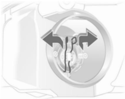
4. Desenclave el clip elástico de los resaltes de fijación presionando hacia delante y luego girándolo hacia abajo.
