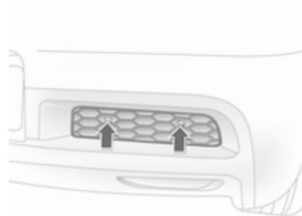
En otros modelos, suelte las lengüetas de bloqueo hacia abajo y levante la tapa.
