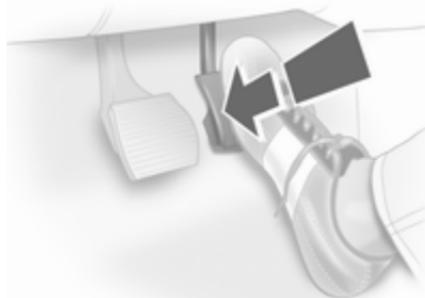
Si se pisa a fondo el acelerador, sobrepasando el punto de presión, se cambia a una marcha más corta dependiendo del régimen del motor.
