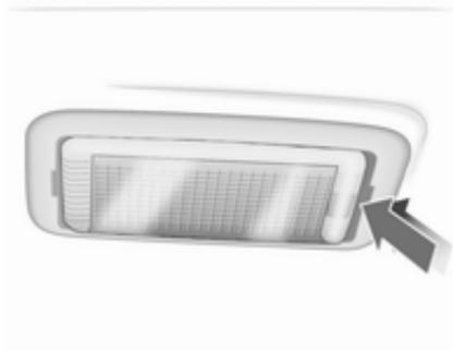
1. Extraiga la lámpara haciendo palanca con un destornillador.
