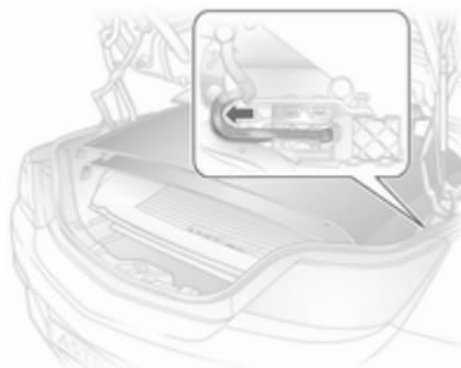
Para evitar daños en el techo abierto, la tapa del maletero o la carga, sólo se puede cerrar la tapa del maletero
