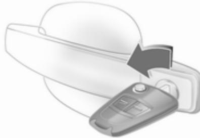
Gire la llave, o la llave de emergencia
