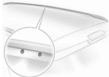
Para fijar el portaequipajes de techo, inserte los pernos de montaje en los orificios indicados en la ilustración.
