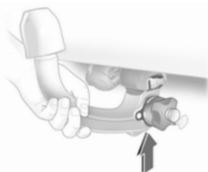
Inserte la barra de rótula tensada en la abertura y presione con fuerza hacia arriba, hasta que enclave de forma audible.
