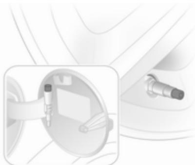
En vehículos con sistema de control de presión de los neumáticos, enrosque el adaptador en la válvula.
