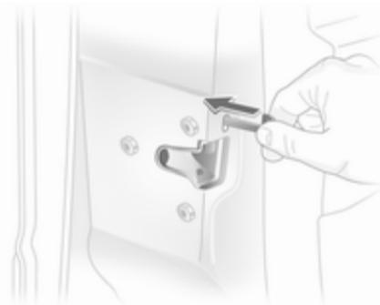
Inserte la llave, o la llave de emergencia  $\triangleright$  22, en la abertura situada encima de la cerradura, en el interior de la puerta, y accione el bloqueo presionando hasta que haga clic. Luego cierre la puerta. El procedimiento debe realizarse para cada puerta. La puerta del conductor también se puede bloquear desde el exterior con la llave. La tapa del depósito de combustible y el portón trasero o la tapa del maletero no se pueden bloquear.
