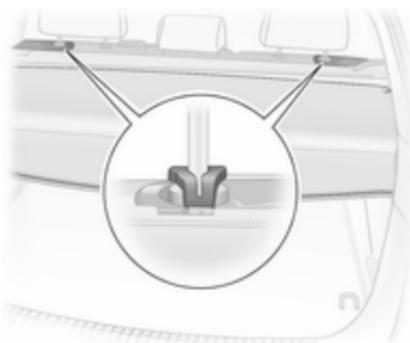
Para tapar la abertura entre la cubierta del compartimento de carga y los respaldos de los asientos traseros, hay una cubierta en el cartucho. Enganche los dos ganchos de la cubierta en las guías de los reposacabezas. Si está montada la red de seguridad, pase los ganchos a través de la malla de la red.
