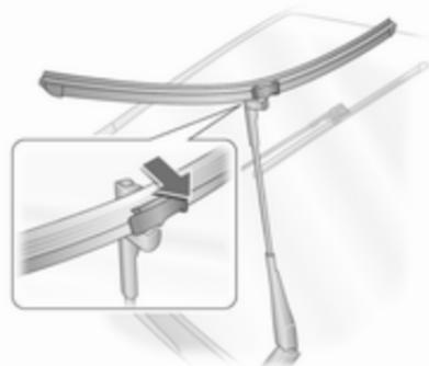
Levante el brazo del limpiaparabrisas, incline la escobilla 90° respecto al brazo del limpiaparabrisas y desmóntela hacia el lado.
