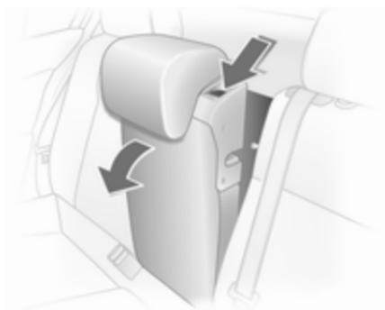
Baje completamente el reposacabezas ⇨ 48. Desenclave el respaldo usando la palanca y abátalo sobre la banqueta de asiento. Si la banqueta de asiento está levantada, abata el respaldo hasta que se enclave.
