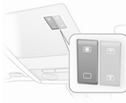
Se acciona mediante un interruptor basculante en la consola del techo.
