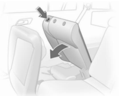
Desenclave el respaldo (de una pieza o dividido) usando el botón de desbloqueo, abátalo y enclávelo.
