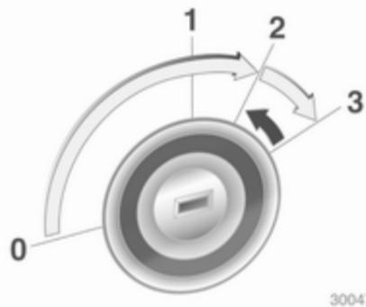
Accione el embrague y el freno, cambio automático en **P** o **N**, no acelere; con motor diésel: gire la llave a la posición 2 para el precalentamiento y espere hasta que se apague el testigo de control ; gire la llave a la posición 3 y suéltela cuando el motor esté en marcha.
