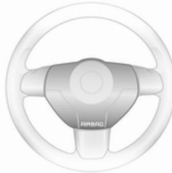
El sistema de airbags frontales se compone de un airbag en el volante y uno en el tablero de instrumentos, en el lado del acompañante. Se pueden identificar por el rótulo **AIRBAG**.
