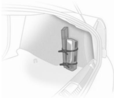
Fije el triángulo de advertencia y el botiquín en el panel derecho del compartimento de carga usando dos cintas.
