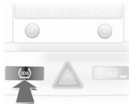
Tras un cambio de rueda, se debe inicializar el sistema: infle los neumáticos a la presión prescrita, conecte el encendido, mantenga pulsado el botón **DDS** durante unos 4 segundos, el testigo de control (L) parpadeará tres veces.
