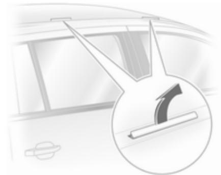
Levante las tapas de las aberturas de montaje.
