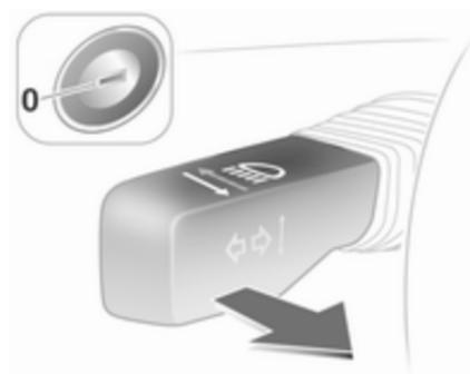
Los faros y las luces de marcha atrás se encienden durante unos 30 segundos después de activar el sistema y de cerrar la puerta del conductor.
