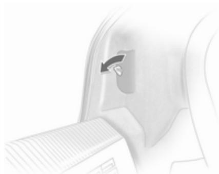
1. Para sustituir las bombillas, gire el cierre y levante la tapa en el compartimento de carga.
