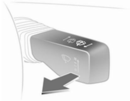
Tire de la palanca. Se pulveriza líquido de lavado sobre el parabrisas y los limpiaparabrisas se accionan durante varios ciclos.
