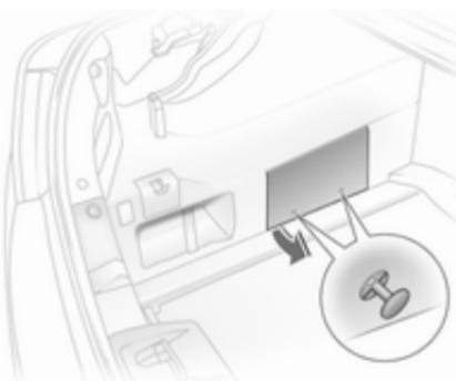
Para abrir, tire de ambos botones, extraiga los clips y levante la tapa.
