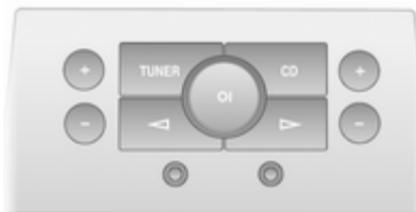
Twin Audio ofrece la posibilidad de escuchar una fuente de audio distinta a la seleccionada en el sistema de infoentretenimiento. Sólo permite controlar una fuente de sonido que no esté activada en ese momento en el sistema de infoentretenimiento.
