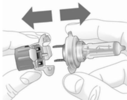
5. Inserte el portalámparas, enclavando las dos lengüetas en el reflector y gírelo en sentido horario para fijarlo.
