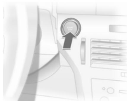
Pulse el botón **Start/Stop**. Se conecta el encendido. Se desactivan el inmovilizador electrónico y el bloqueo del volante.
