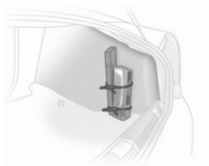
Fije el triángulo de advertencia y el botiquín en el panel derecho del compartimento de carga usando dos cintas.
