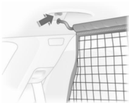
En cada lado del marco del techo hay dos aberturas de montaje: enganche y enclava la varilla de la red en un lado, comprima la varilla para engancharla y enclavarla en el otro lado.
