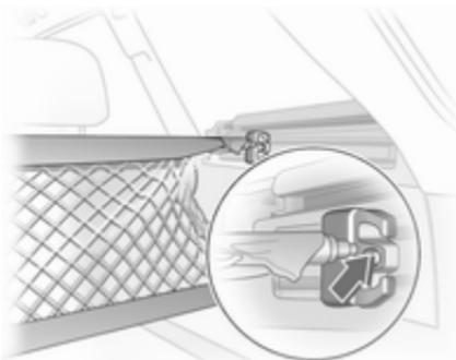
Inserte un adaptador en cada carril: doble hacia arriba la placa del asidero, inserte el adaptador en la ranura superior e inferior del carril y muévalo hasta la posición deseada. Gire la placa del asidero hacia arriba para bloquear el adaptador. Las varillas de la red deben extenderse antes
