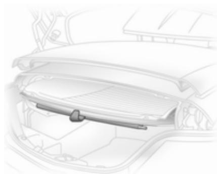
En el TwinTop: El sistema de carga fácil (Easy Load) permite cargar cómodamente el compartimento de carga cuando el techo está abierto. El techo plegado en el compartimento de carga se puede elevar unos
