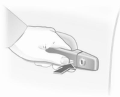
Para cerrar, toque el campo del sensor en la manilla de la puerta hasta que todas las ventanillas estén completamente cerradas.
