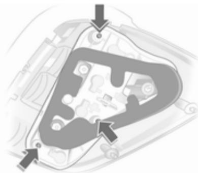
4. Desenrosque los tres tornillos con un destornillador y desmonte el portalámparas. Herramientas del vehículo ↻ 199.
