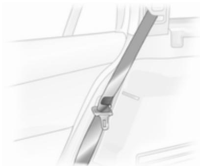
Antes de volver a colocar el respaldo en posición vertical, guíe el cinturón de seguridad a través de las guías del cinturón para protegerlo de daños. Pulse el botón de desbloqueo y enderece los respaldos del asiento trasero, asegurándose de que los mecanismos de bloqueo enclaven audiblemente.
