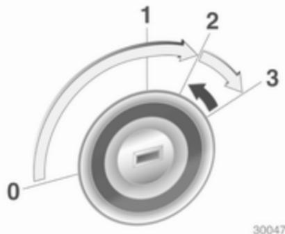
Gire la llave a la posición 1. Mueva ligeramente el volante para desactivar el bloqueo. Accione el embrague y el freno, cambio automático en **P** o **N**, no acelere; con motor diésel: gire la llave a la posición 2 para el precalentamiento y espere hasta que se apague el testigo de control ; gire la llave a la posición 3 y suéltela cuando el motor esté en marcha.
