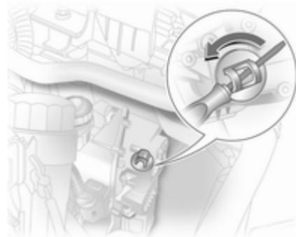
Si hay que retirar el vehículo de la calzada para no obstaculizar el tráfico, suelte el embrague del siguiente modo (sólo en vehículos con cambio manual automatizado de 5 velocidades):
