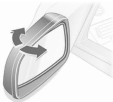
Para la seguridad de los peatones, los retrovisores exteriores basculan de su posición de montaje normal al recibir impactos de una determinada fuerza. Vuelva a colocar el retrovisor en su posición presionando ligeramente sobre la carcasa.
