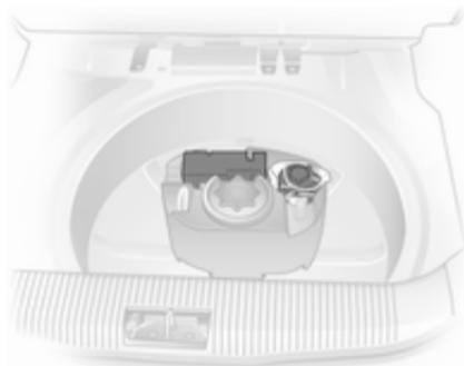
El juego de reparación de neumáticos está en el compartimento portaobjetos debajo de la cubierta del piso en el compartimento de carga.
