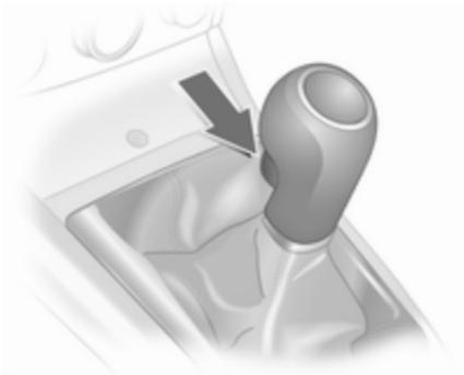
Marcha atrás: con el vehículo parado, espere 3 segundos después de pisar el pedal de embrague, apriete el botón de la palanca y engrane la marcha.
