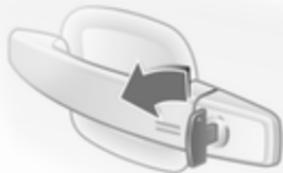
La llave de emergencia sólo puede bloquear o desbloquear la puerta del conductor. Desbloqueo del vehículo completo ↻ 25. En vehículos con sistema de alarma antirrobo, se puede disparar la alarma al desbloquear el vehículo. Desactive la alarma desconectando el encendido.
