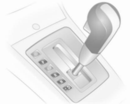
La palanca selectora sólo puede moverse de la posición **P** o **N** con el encendido conectado y el pedal del freno pisado (bloqueo de la palanca selectora).
