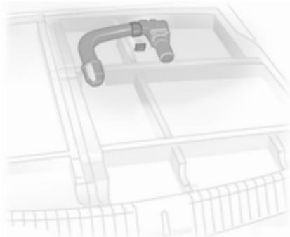
En el modelo Sedán, la barra de rótula está en una bolsa, sujeta con una cinta en la Cargo box del compartimento de carga. En el Station Wagon, la barra de rótula está sujeta con un cinta en un compartimento del hueco de la rueda de repuesto en el compartimento de carga.
