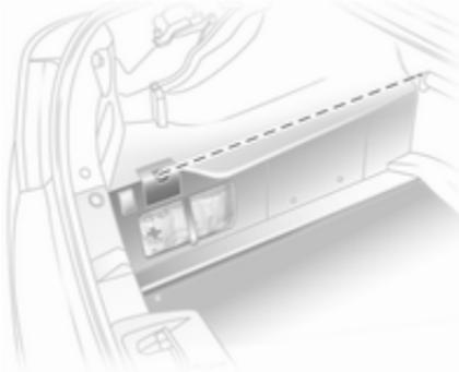
El techo sólo podrá abrirse si la carga en el compartimento de carga no supera la altura de la persiana del compartimento de carga ni sobresale lateralmente. No se debe sobrepasar la altura de carga. La persiana del compartimento de carga debe estar en posición recta; los objetos que haya debajo de la misma no deben presionar hacia arriba. En caso contrario, se pueden dañar el techo y la carga.
