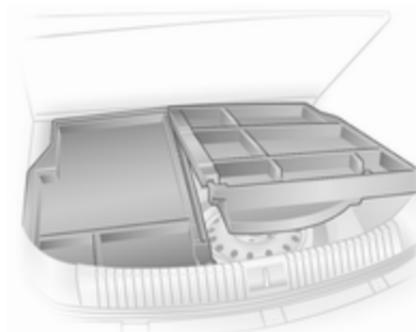
Caja con tapa abatible bajo la cubierta del piso usada para dividir el compartimento de carga.
