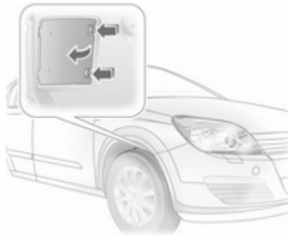
Las bombillas de las luces exteriores delanteras se sustituyen a través de unas aberturas en los pasarruedas
