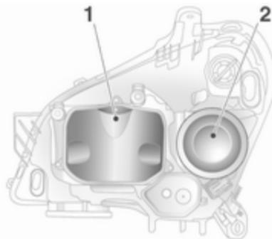
Los faros tienen sistemas independientes para la luz de cruce 1 (bombillas interiores) y la luz de carretera 2 (bombillas exteriores).
