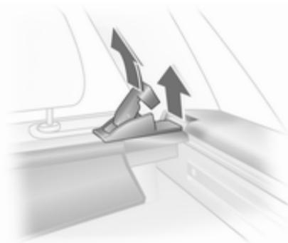
Abra la cubierta del compartimento de carga y desenganche los ganchos de los reposacabezas.
