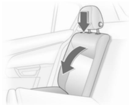
Baje completamente los reposacabezas o desmóntelos ⇨ 48.
