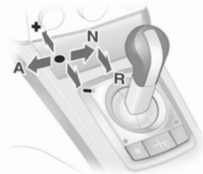
La palanca selectora siempre debe moverse en la dirección apropiada todo lo que sea posible. Una vez que la suelte, volverá automáticamente a la posición central.
