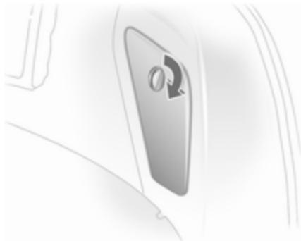
1. Para cambiar las bombillas en el lado derecho, utilice una moneda para girar el cierre y baje la tapa.
