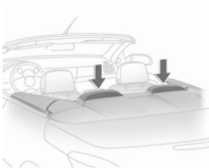
Las barras antivuelco desplegadas están situadas entre los reposacabezas traseros y la tapa del maletero. En caso de vuelco, choque frontal o lateral, las barras antivuelco se despliegan hacia arriba en milisegundos. Se despliegan junto con los sistemas de airbag frontales y laterales.
