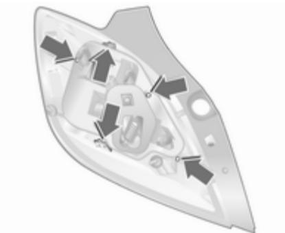
5. Desmonte la junta del tornillo de fijación. Presione las lengüetas de bloqueo en el exterior del portalámparas hacia fuera y desmonte el portalámparas.
