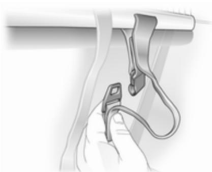
Incline hacia arriba el regulador de longitud de la correa tensora de la red y suelte la correa. Desenganche las varillas de la red de seguridad de los soportes en el marco del techo. Enrolle la red de seguridad y fíjela con una cinta.
