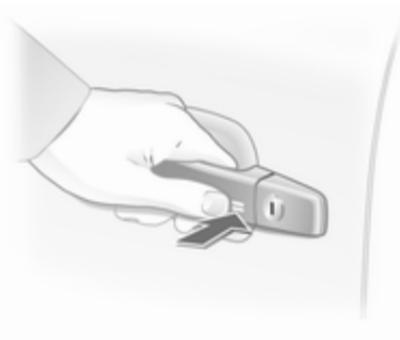
Toque el campo del sensor en la manilla de una de las puertas delanteras.
