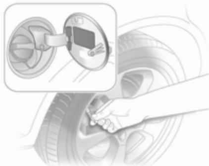
Desenrosque el tapón de la válvula con la llave para tapones de válvulas que hay en la tapa del depósito.
