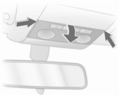
1. Desenclave el difusor, presione ligeramente hacia abajo y desmóntelo inclinado hacia abajo.
