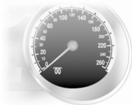
El testigo de control
