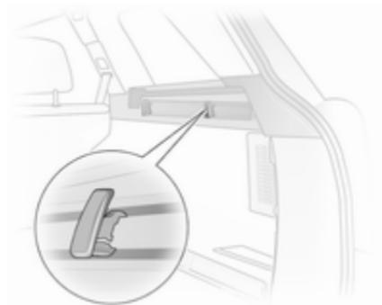
En el Station Wagon, monte los ganchos en la posición deseada en los carriles: inserte el gancho en la ranura superior del carril y encájelo en la ranura inferior.
