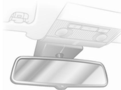
El deslumbramiento producido por los vehículos que nos siguen de noche se reduce automáticamente.
