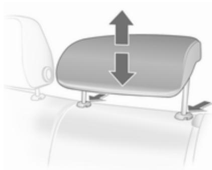
Tire hacia arriba del reposacabezas o pulse los resortes de retención para desbloquearlos y baje el reposacabezas.
