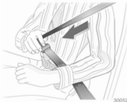
Extraiga el cinturón del retractor, guñelo por encima del cuerpo sin retorcerlo e inserte la lengüeta en el cierre. Durante el viaje, tense frecuentemente el cinturón abdominal tirando suavemente de la banda torácica.
