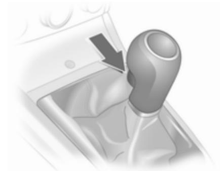
Para engranar la marcha atrás: con el vehículo parado, espere 3 segundos después de pisar el pedal de embrague, apriete el botón de la palanca selectora y engrane la marcha.
