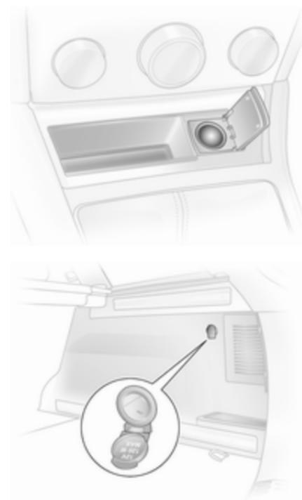
Los modelos Station Wagon tienen una toma adicional para accesorios en el compartimento de carga.
