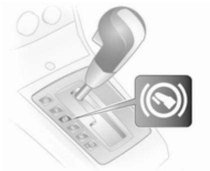
En la posición **P** o **N**, se ilumina en rojo el testigo de control (🚫) en la escala indicadora cuando la palanca selectora está bloqueada. Si la palanca selectora no está en la posición **P** al desconectar el encendido, parpadeará el testigo de control (🚫) y **P** en la escala indicadora.
