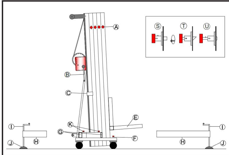
1. Colocar la torre elevadora sobre una superficie plana y firme en su emplazamiento de trabajo .
