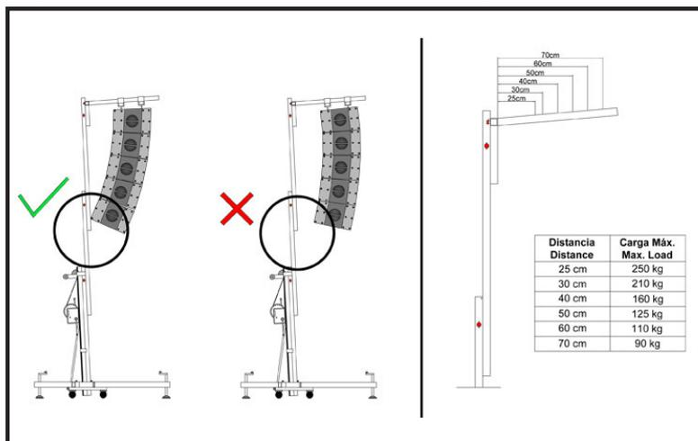
6. Elevar: Girar la manivela del cabestrante (B) en el sentido de las agujas del reloj elevando la carga hasta la posición deseada, comprobando que los gatillos de seguridad (A) están en posición accionados (T).
