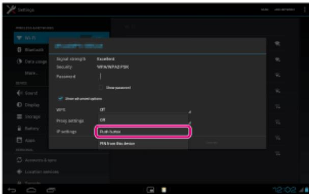
6. Pulse el botón WPS del router Wi-Fi (punto de acceso). Los ajustes de Wi-Fi del tablet se configuran automáticamente.
