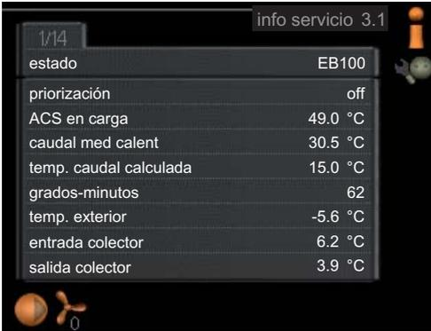
Muestra información sobre el estado de funcionamiento real de la bomba de calor (temperaturas actuales, etc.). No permite efectuar cambios.
