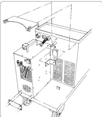
ventilación y por consiguiente el buen funcionamiento. Montar el mango, las ruedas, el apoya bombona y el eventual grupo de enfriamiento.
