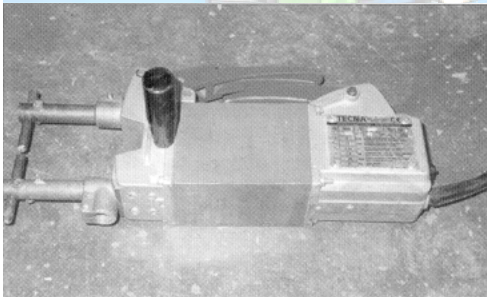
Fig. 2.11. Soldadura por puntos.
