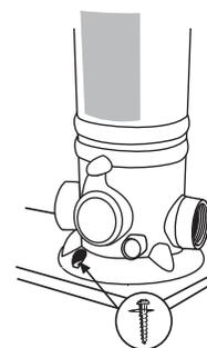
Para una mejor estabilidad, el Ciclador puede ser montado en una base usando pernos de cabeza plana Phillips.
