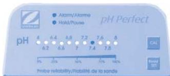
**Observación:** Todas las situaciones de alarma del aparato se avisan mediante el diodo rojo "Alarm/Alarma" parpadeante.
