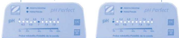
• **El diodo "Alarm/Alarma" parpadea, el diodo "Hold/Pause" se enciende y la bomba deja de dosificar.**
