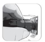
Gire la rosca de seguridad del conector hacia la derecha, hasta el tope.
