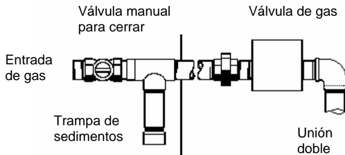
La cañería de gas debe tener una trampa para sedimentos, y una válvula de cierre ubicada en las inmediaciones del equipo.
