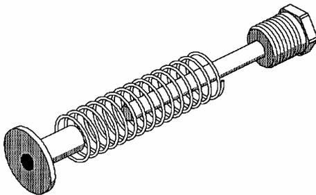
Además de la válvula reguladora Unitherm hay otra válvula automática de paso en el cabezal de entrada/salida. Cuando el regulador Unitherm abre o cierra en función de la temperatura del agua, la válvula de by-pass responde a cambios en la presión del sistema, manteniendo un caudal normal constante bajo las diferentes presiones dictadas por el estado del filtro y la bomba.
