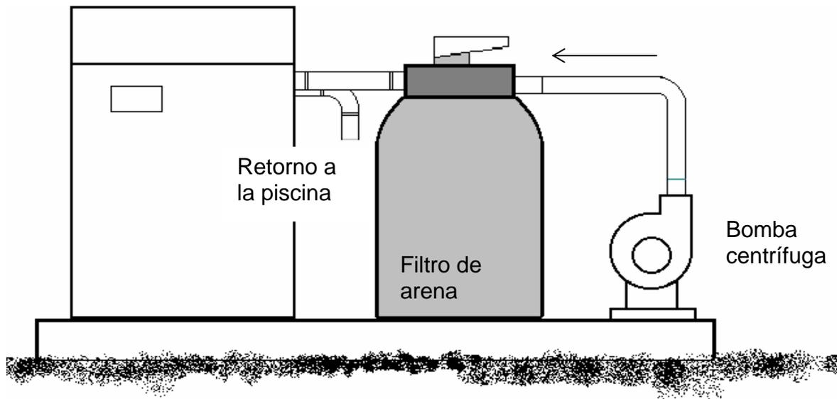
Para ello se podrá utilizar un timer (programador a reloj) con doble interruptor. Uno de ellos comandará la bomba y el otro se intercalará en el circuito interno del calefactor.
