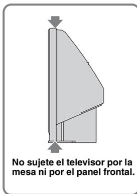
Cuando mueva el televisor, coloque una mano en el orificio de la parte inferior mientras toma la parte superior con la otra mano, como se muestra en la ilustración siguiente.
