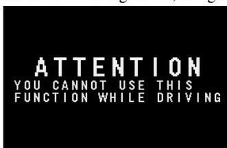
Al estacionar el vehículo en un lugar seguro y aplicar el freno de estacionamiento, la imagen aparece en la pantalla.
