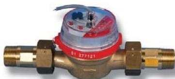
El caudalímetro RESOL V40 se usa para medir el caudal del agua en el circuito solar del sistema. Cuando monte dicho caudalímetro en el sistema, tenga en cuenta el sentido del flujo indicado en el caudalímetro. Para estabilizar el régimen del flujo en la tubería, deje un espacio de entrada y salida de 30 cm como mínimo en cada lado del caudalímetro. **Nota: los caudalímetros de la versión V40 0,6 hasta 2,5 se pueden montar horizontal y verticalmente. Los**
