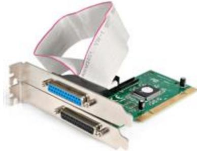
La tarjeta adaptadora PCI con dos puertos paralelos EPP/ECP, modelo PCI2PECP, se puede instalar en una ranura PCI disponible, mediante lo cual se agregan dos puertos IEEE 1284 a un PC, con velocidades de transferencia de datos de hasta 1,5 Mbps (hasta 3 veces más rápido que los puertos paralelos integrados).
