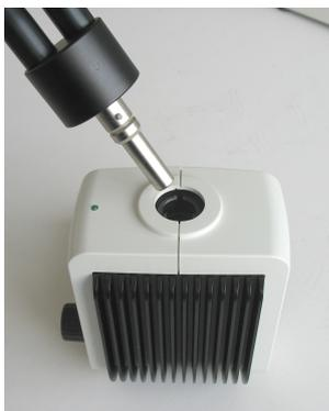
La guía de luz se inserta en la toma de la guía de luz (1) hasta el tope. Para asegurar un ajuste perfecto y una iluminación óptima, la guía de luz debe encajar en la ranura (se oye un pequeño clic).
