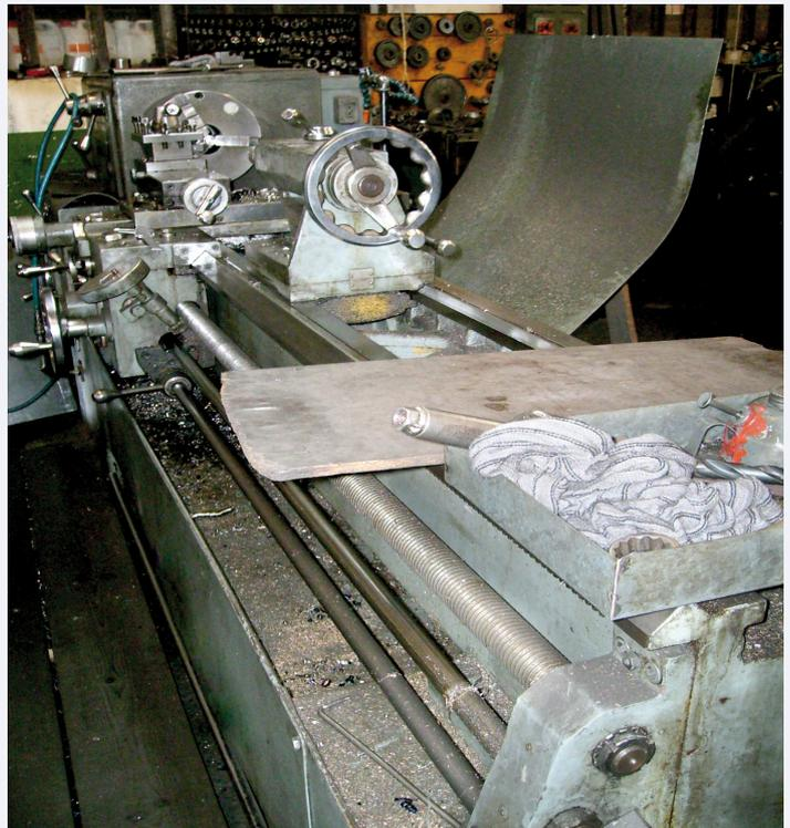
*Vista general del torno con una chapa protectora colocada de forma rudimentaria que no consigue una protección eficaz*
