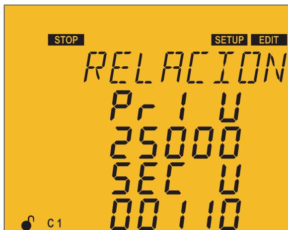
En este punto se configura el valor de primario y secundario del transformador de tensión.
