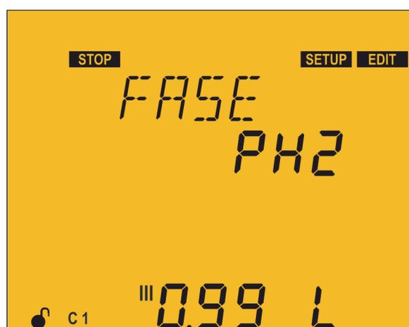
Si se ha seleccionado una conexión con una única corriente (3U 1C o 2U 1C), en esta pantalla se selecciona una de las 6 posibles fases que se indican en la **Tabla 41**.
