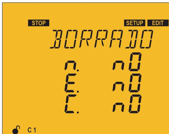
En este punto se configura el borrado *YES* o *no*, de los máximos y mínimos, las energías y el número de conexiones de los escalones.
