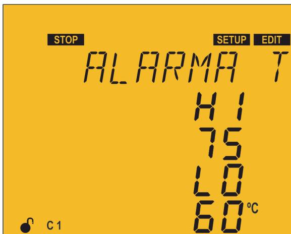
En este punto se configuran los umbrales a partir de los cuales se activará la alarma de temperatura ( $E_{10}$ ).
