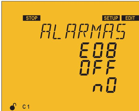
Esta pantalla se repite para cada tipo de Error o Alarma (de E01 a E17), ver **Tabla 9**. En ella se configura la habilitación o deshabilitación de cada error o alarma y si queremos asociarlo a la activación de un relé o de una salida digital.
