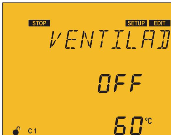
En este punto se configura la activación de la salida de relé asociada al ventilador.
