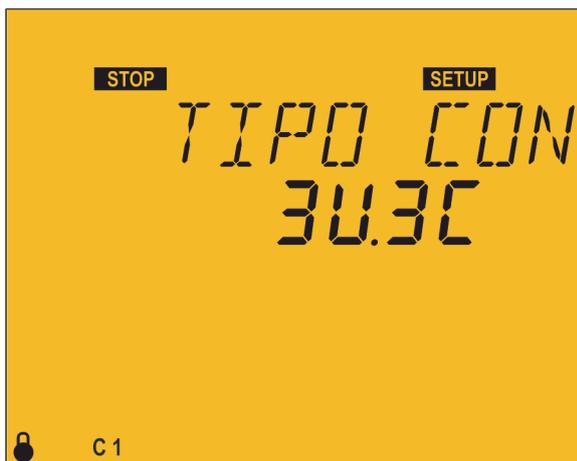
En este punto se selecciona el tipo de conexión de la instalación, donde:
