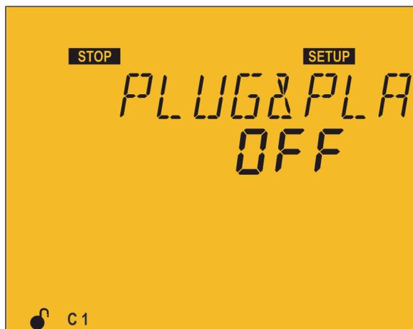
El Plug&Play es una ayuda a la hora de configurar el equipo, ya que configura automáticamente los parámetros básicos y necesarios para que el equipo pueda regular correctamente.
