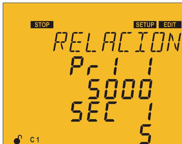
En este punto se configura el valor de primario y secundario del transformador de corriente.
