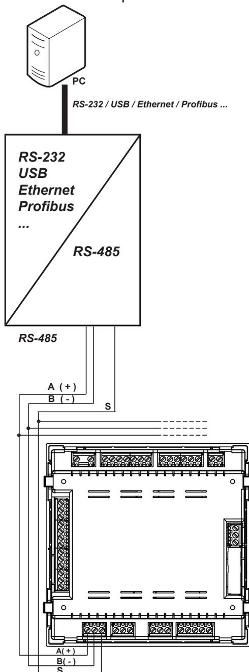
Figura 16: Esquema de conexionado RS-485.
