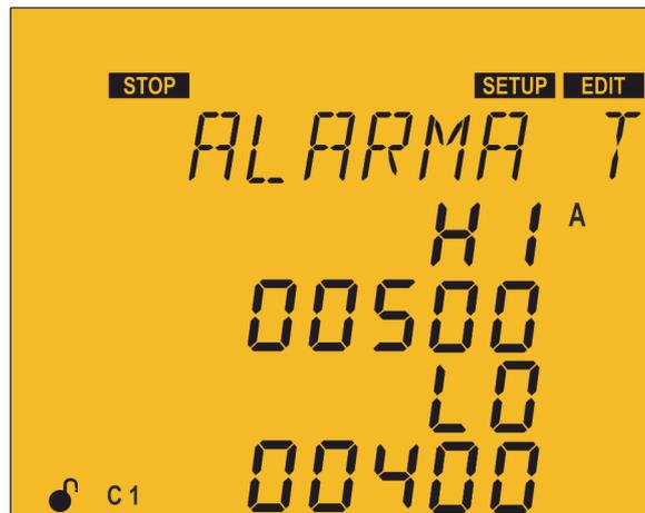
En este punto se configuran los umbrales a partir de los cuales se activará la alarma del % del valor de THDI x corriente ( $E_{09}$ ).
