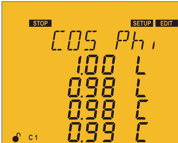
El cos φ permite fijar cual es el factor de potencia deseado en la instalación. El **Computer SMART III FAST** insertará el número de condensadores necesario para acercarse lo más posible a este valor objetivo. Dado que la regulación es por escalones, éste no efectuará ninguna maniobra hasta que la demanda no compensada sea, al menos, de un 70% de la potencia del escalón más pequeño o el exceso de compensación sea de un 70% de la potencia del escalón más pequeño.
