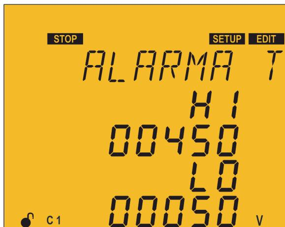
En este punto se configuran los umbrales de tensión fase-fase a partir de los cuales se quiere que salte la alarma de sobretensión (E05) y la alarma de falta de tensión (E06).
