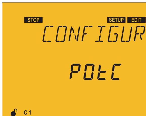
En este punto se configura el parámetro a visualizar en la barra analógica ( “4.4.3. BARRA ANALÓGICA”)
