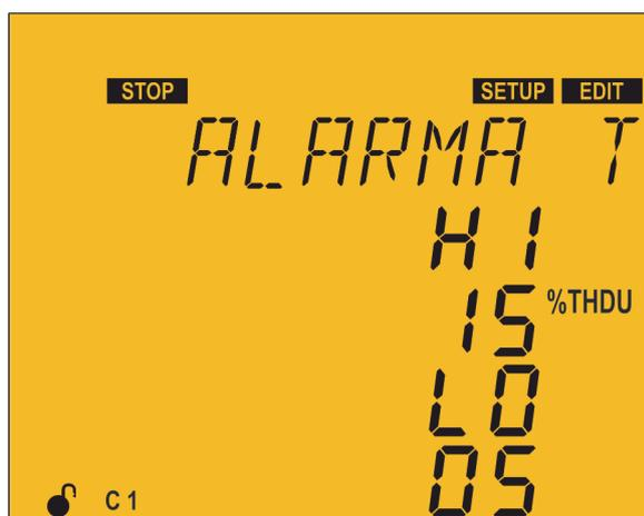
En este punto se configuran los umbrales a partir de los cuales se activará la alarma de THD de tensión (*EOB*).
