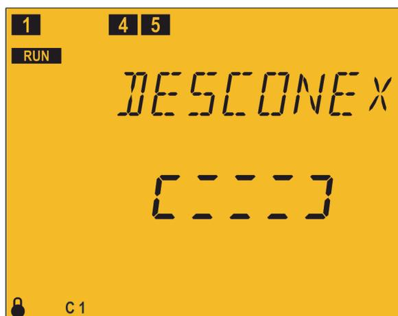
Pantalla de desconexión, sirve para que el equipo desconecte automáticamente todos los escalones antes de entrar en configuración.
