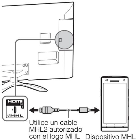
La función MHL (enlace de alta definición móvil) permite al TV comunicarse con un dispositivo compatible con MHL cuando está conectado al TV. El TV puede cargar la batería del dispositivo compatible con MHL cuando está conectado al TV mientras se reproducen fotos, música o video desde el dispositivo. Puede utilizar el control remoto del TV para controlar el dispositivo compatible con MHL cuando está conectado al TV.
