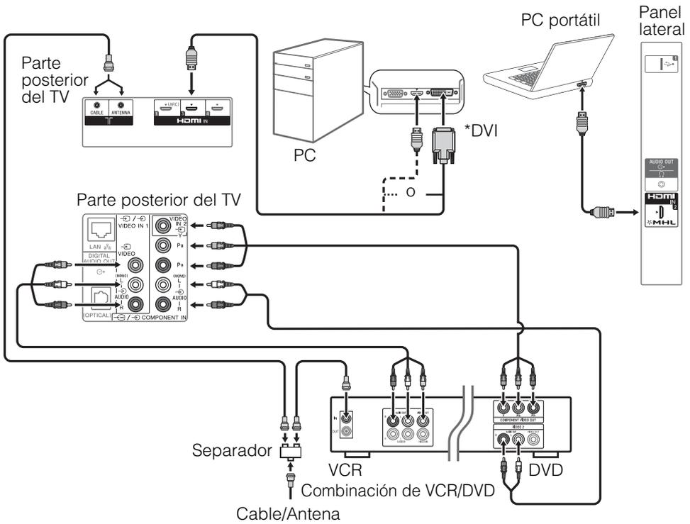
\* DVI no permite el uso de señales de audio. Conecte la salida de audio del PC a los altavoces del PC o a un receptor A/V para escuchar el sonido del la PC.
