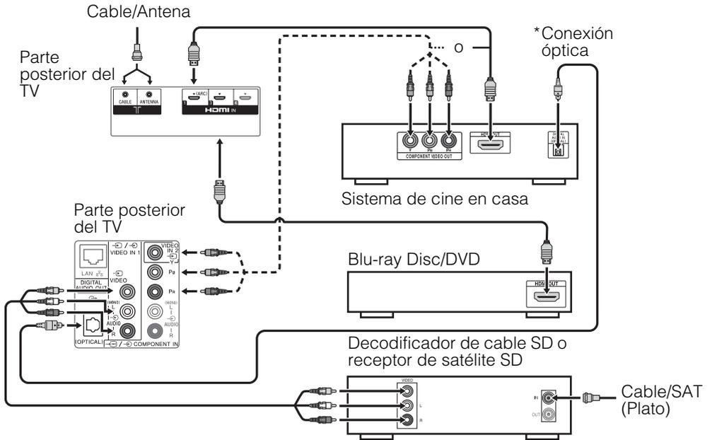
\* La conexión óptica sólo es necesaria para un sistema de cine en casa que no soporta ARC cuando se conecta con HDMI.
