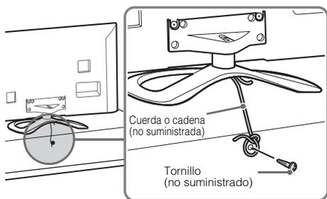
La longitud del tornillo tipo M4 varía en función del diámetro de la cuerda o de la cadena. Consulte la siguiente ilustración.
