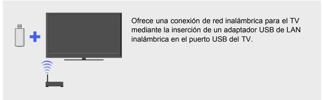
Al insertar el adaptador USB de LAN inalámbrica UWA-BR100 (a partir de diciembre de 2010) en el puerto USB del TV, podrá establecer una conexión de red inalámbrica.
