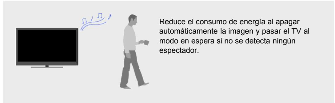
Esta función reduce el consumo de energía al supervisar la presencia de espectadores a través del sensor incorporado. Cuando no se detecta ningún espectador frente al TV durante un tiempo preestablecido, la imagen se apaga de forma automática y sólo se deja encendido el sonido. Asimismo, después de 30 minutos en el modo sin imagen, el TV pasa al modo en espera.
