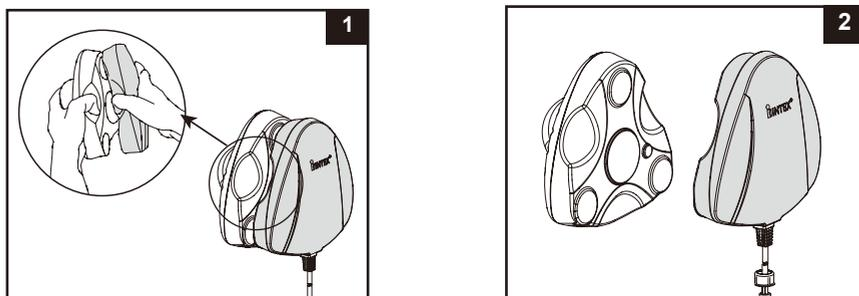
2. Coloque el transmisor (2) en la parte exterior de la pared de la piscina y coloque la luz (1) en la parte interna de la pared de la piscina sumergida bajo el agua. Verifique que los polos magnéticos del transmisor coinciden correctamente con los polos magnéticos del artefacto de luz. **Vea el dibujo (3).**
