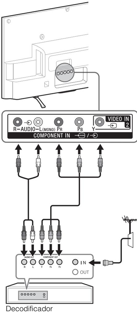
■ Sistema de cable o Sistema de antena VHF/UHF
