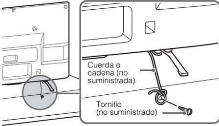
La longitud del tornillo tipo M4 varía en función del diámetro de la cuerda o de la cadena. Consulte la siguiente ilustración.
