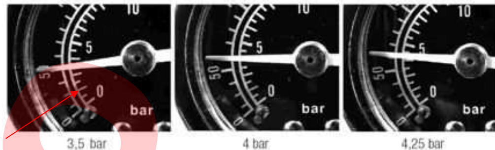
Observar que después de 0, la primera indicación "larga" es de 2 bar ( → ) Observe that after 0 mark, first "long" indication is 2 bar ( → )
