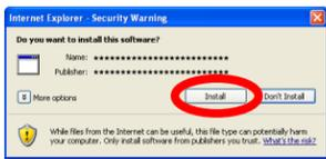
Así se instalará el programa de visor (ActiveX Controls) necesario para que las imágenes de la cámara se muestren correctamente. Se deben instalar programas de visor para ver imágenes MPEG-4 y MJPEG, así como para utilizar funciones de audio.
