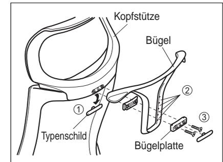
\* Verwenden Sie nicht die Schraubenplatte und die Schrauben, die für den Stuhl mit extra hoher Rückenlehne mitgeliefert wurden.
