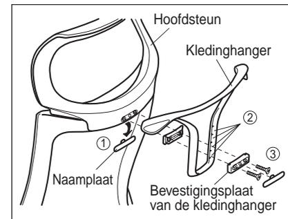
\* De schroefplaat en schroeven die werden geleverd bij stoelen met een extra hoge rugleuning mogen niet worden gebruikt.
