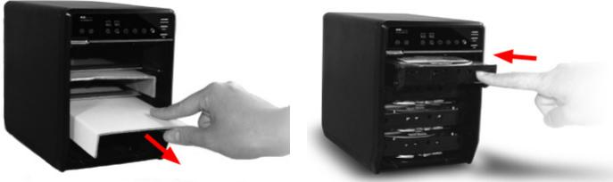
2. Una vez que todos los discos duros se encuentran instalados, vuelva a colocar la jaula metálica y cierre la puerta frontal del gabinete. Asegúrese que el fondo de la jaula esté correctamente en su carril antes de cerrar la cubierta.
