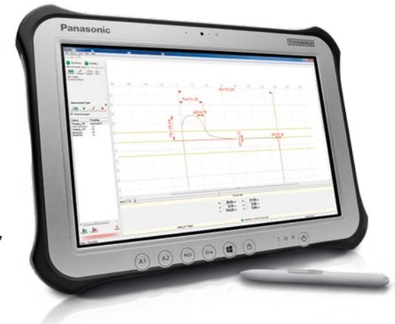
Con el medidor universal CALIPRI podrá calibrar con total precisión y comodidad los perfiles de ruedas, discos de freno, raíles y agujas.
