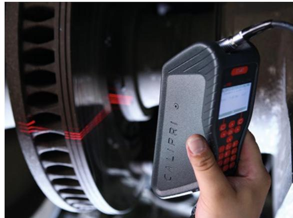
El medidor de perfiles inalámbrico CALIPRI apenas requiere formación para el personal y permite obtener resultados de medición precisos, independientemente del usuario.
