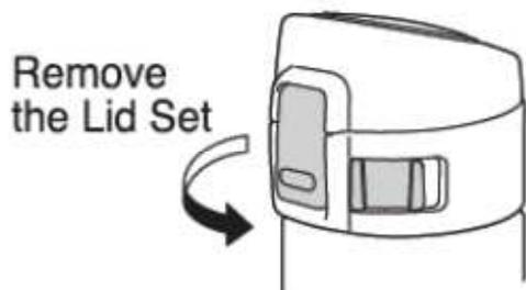
1- Gire el Conjunto Pieza-Tapa hacia la izquierda para su apertura. El cierre se efectuará girando el Conjunto Pieza Tapa hacia la derecha.
