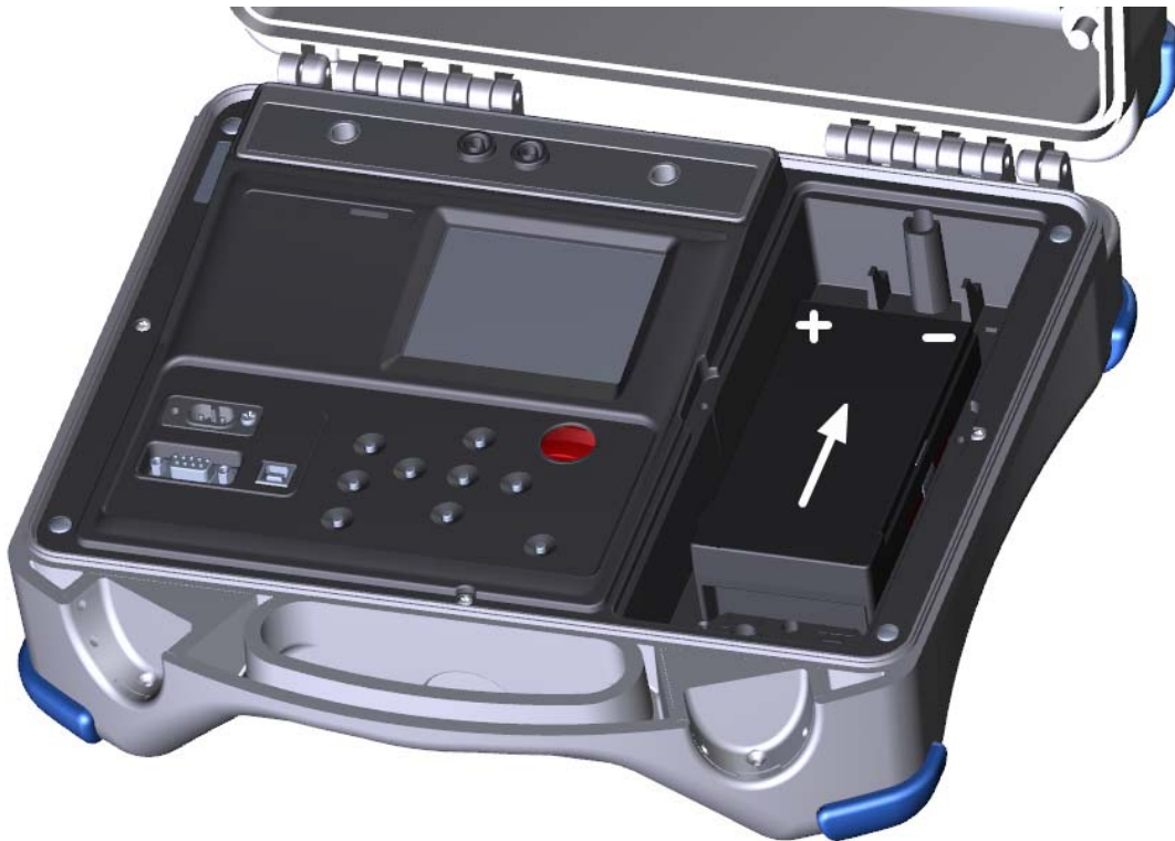
Figura 7.2: Batería correctamente colocada
