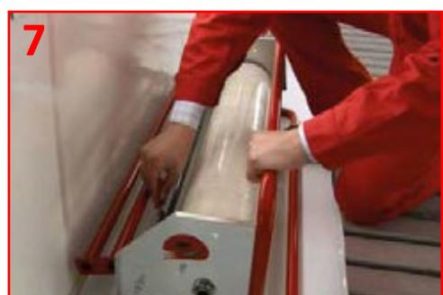
*Hinweis: Wenn sich Leuchten, Sichtfenster usw. an der Kabinenwand befinden ist es möglicherweise einfacher die Colad Film4Booth anstatt mit dem Applikator mit einer Andruckrolle anzubringen. Die Folie lässt sich dann ganz einfach z. B. mit einer Tapezierbürste glätten.*
