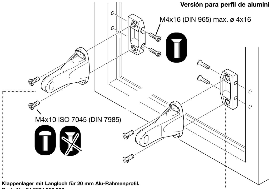
**Klappenlager mit Langloch für 20 mm Alu-Rahmenprofil.**
