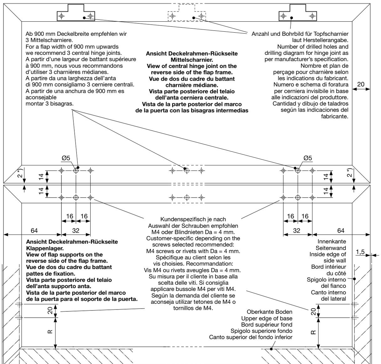
\*) = bei verstellbaren Mittelscharnieren 2-4 mm
