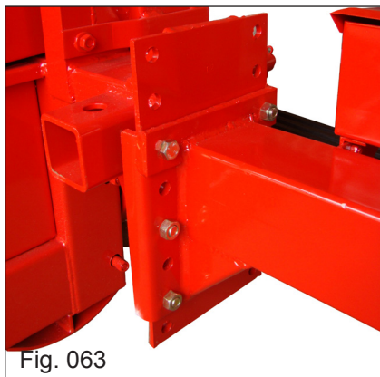
Fig. 063 Posición de montaje de la torre desde el tercer punto hacia la boca de entrada
