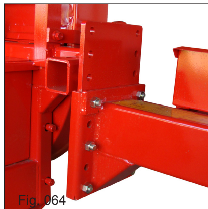
Fig. 064 Posición de montaje de la torre desde el tercer punto hacia la plataforma de hierba.
