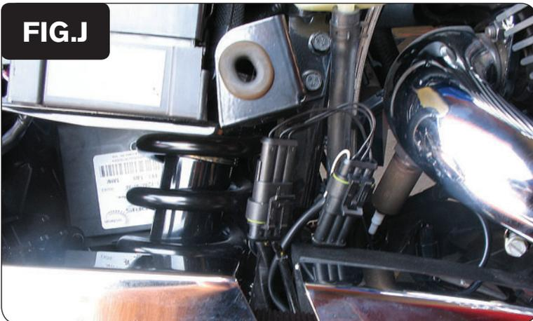
16. Conectar el mazo de cables del PCV en línea con el mazo de cables de serie y el conector del captador de posición del cigüeñal (Fig. J).
