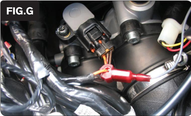
11. Localizar el mazo de cables del Sensor de Posición del Acelerador, a la izquierda de los cuerpos del acelerador.
