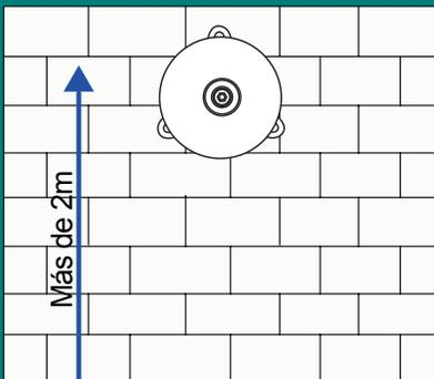
2. Tome como referencia la base de la campana para realizar las marcas de perforación. Realice las perforaciones e inserte los taquetes.
