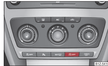
Fig. 2 Cuadro de interruptores: Tecla del sistema de START-STOP (ARRANQUE-PARADA)
