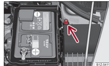
Fig. 3 Ayuda de arranque en vehículos con sistema de START-STOP
