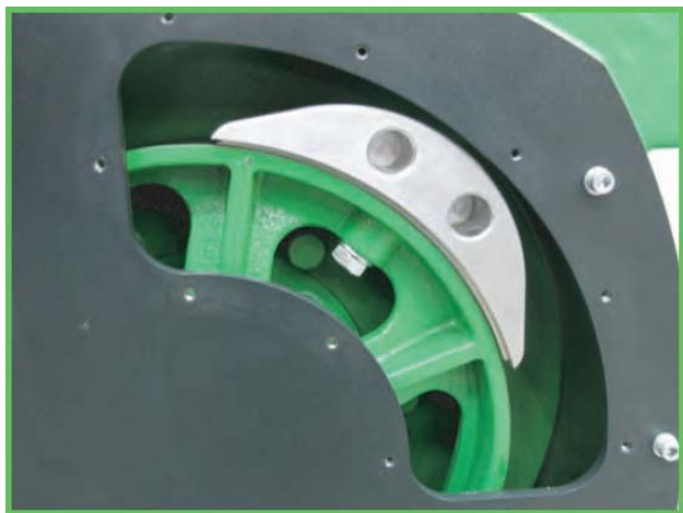
Figura 4 Ajuste de las cuñas
