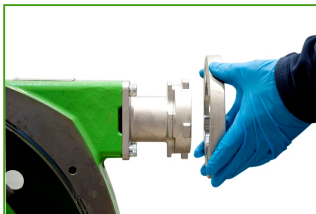
Figura 8 Ajustar la brida del orificio
