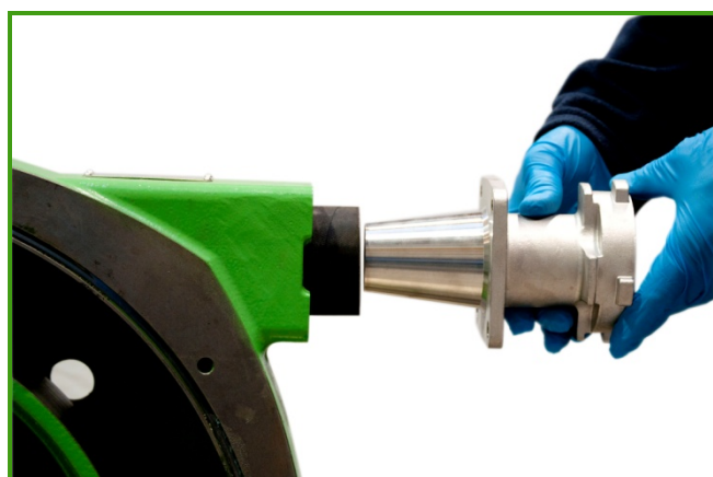
Figura 7 Ajuste de la brida del orificio
