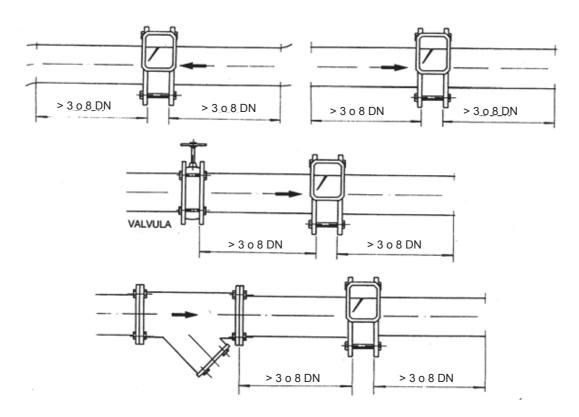
En la serie DP-65, hasta DN-300, el montaje se realiza ENTRE BRIDAS locas.
