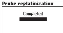
Remueva la sonda desde la solución de replatinización y enjuague con agua desionizada.
