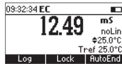
La conductividad del agua natural muestra un fuerte comportamiento de temperatura no lineal.
