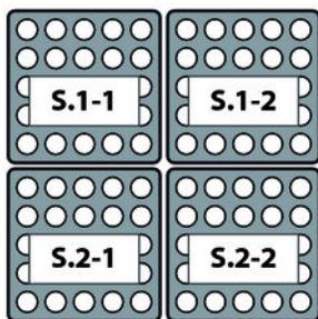
En una configuración de maestro/esclavos, se pueden combinar, como máximo, cuatro unidades de un mismo tipo, formando así un matricial de 10x10 LEDs. Todos los efectos se visualizan entonces por medio del matricial agrupado.
