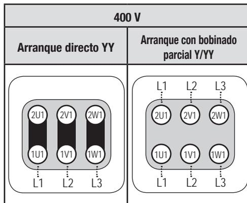
**¡ATENCIÓN!** El incumplimiento provoca campos giratorios contrarios y la avería del motor. Tras el arranque del motor mediante bobinado parcial 1 se debe conectar como máximo al cabo de un segundo de retardo el bobinado parcial 2. El incumplimiento puede afectar a la vida útil del motor.
