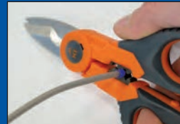
Función crimpadora para terminales desde 1 a 6 mm 2
