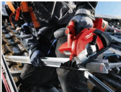
Aplicación Sierra circular a batería SCM 22-A
